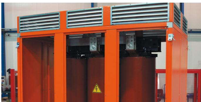
■ 1600-kVA-Gießharztransformator in einem kundenspezifischen IP23-Gehäuse. Power bietet eine breite Palette von maßgeschneiderten IP-Schutzboxen bis IP54 mit einem speziellen Belüftungssystem, das die korrekte Wärmeableitung ermöglicht, die vom Transformator erzeugt wird. Die Schwingungsdämpfer garantieren eine entsprechende Geräuschpegel-Reduzierung. Aufstellungsort: Spanien
