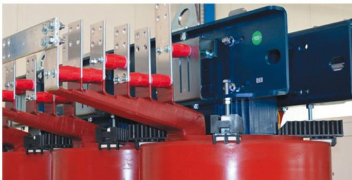
■ 1000 kVA Gießharztransformator mit Multispannungsausgängen auf der Sekundärseite. Dieser Transformator wird als Schnittstelle zwischen verschiedenen Wechselrichtern der Photovoltaikmodule und der Verteilungsleitung verwendet und erfordert daher eine sehr widerstandsfähige Struktur aufgrund des häufigen Ein- und Ausschaltens der Anlage.
