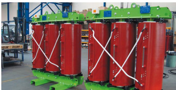
■ 2 x 1250 kVA, 20 / 0,4 kV Gießharztransformatoren mit kundenspezifischem Anstrich und Veredelungen. Fa. Power Sp. z o.o. bietet allen Kunden maßgeschneiderte Gießharztransformatoren an, die es vorziehen, ihre Kunden direkt mit eigenen Transformatoren zu versorgen. Aufstellungsort: Deutschland
