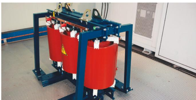
■ 250 kVA 21 / 0,4 kV Gießharztransformator mit rüttelsicherer Verstärkungsstruktur für den Einbau in seismisch aktiven Bereichen. Diese technische Lösung kann bei der Installation in den Bergwerken, Kernkraftwerken und seismisch aktiven Gebieten verwendet werden. Die richtigen Berechnungen werden nach Kundenanforderung gemäß IEEE 693-2005, GOST 17516.1-90 und ETG 1.020 durchgeführt.
