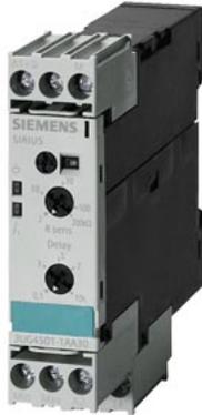
Analoges Überwachungsrelais Füllstandsüberwachung Widerstandsüberwachung von 2 bis 200 kOhm Über- und Unterschreitung Versorgungsspannung AC/DC 24 V DC und AC 50 bis 60 Hz ohne galvanische Trennung zum Messkreis 2 Punkt- oder 1 Punktregelung Auslöseverzögerung 0,5 bis 10 s 1 Wechsler Schraubanschluss Nachfolgeprodukt für 3UG3501-1AC20
